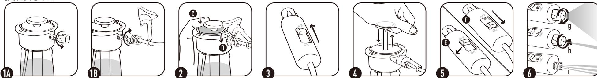
1. (1A) アクアボットのノズルキャップを外し、(1B) チューブのコンプレッションノズルキャップと交換します。
