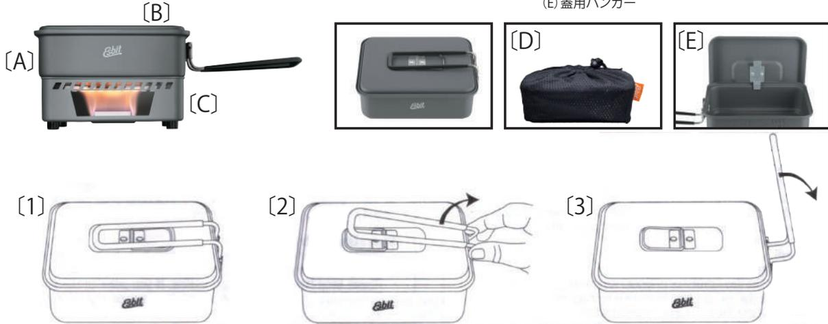
ハンドルを開閉するには、図のようにハンドルを少し押し(図2参照)、ハンドルを目的の位置に完全にスナップします。
